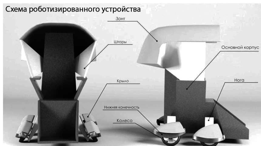
Рис. 3. Макет инвалидного кресла-робота «RESIST 2017», представленный в совместных бакалаврских ВКР на кафедрах ИГД и МиУП
