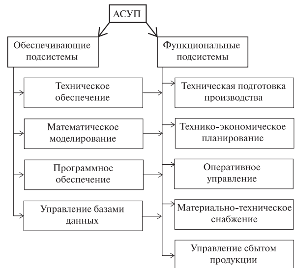
Рис. 2. Модель взаимосвязи обеспечивающих и функциональных подсистем АСУП
